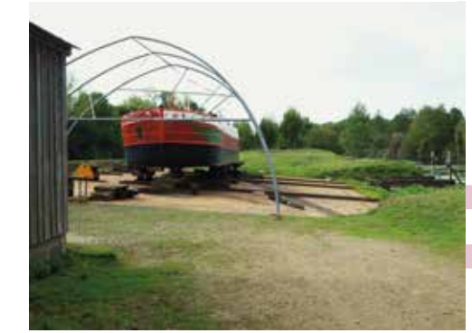
Le sleepway pour mettre à sec les péniches
